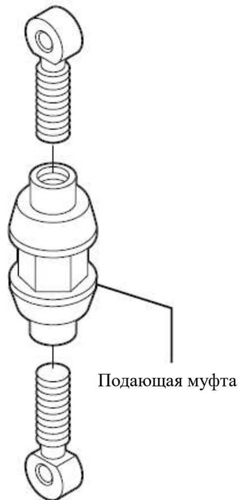
**ПРИМЕЧАНИЕ:** Затягивая зажимные (подающие) муфты как можно сильнее, необходимо оставлять возможность перемещать резак вокруг трубы. (Ручной рычаг облегчает процесс затягивания – 1/2 оборота зажимной (подающей) муфты должно быть достаточно для обеспечения необходимого натяжения).
